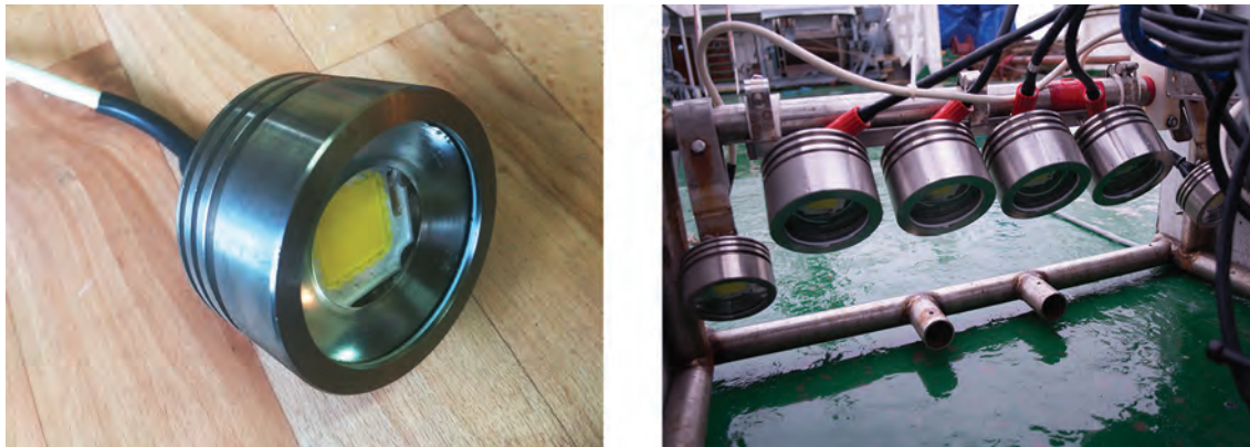
Рис. 3. Матричный светодиод Epistar XY-J45, заключенный в герметичный прочный корпус (слева), установленные источники подводного освещения на раме БНПА «Видеомодуль» (справа).
