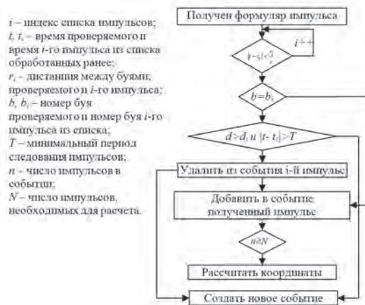
Рис. 3. Блок-схема алгоритма предварительной сортировки
