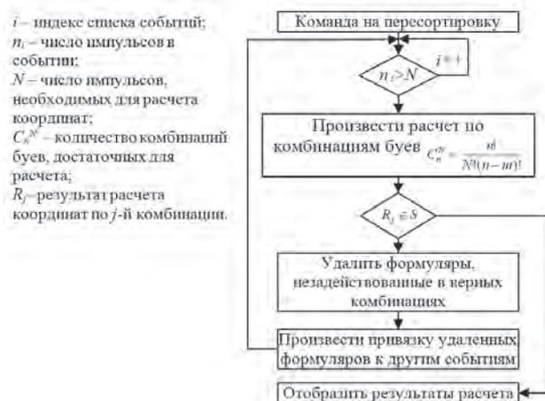
Рис. 4. Блок-схема алгоритма пересортировки
