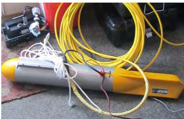
Рис. 2. Гидролокатор бокового обзора (ГБО) «YellowFin».
