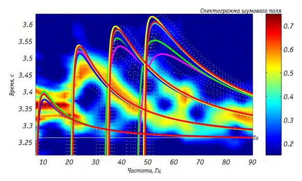
Рис. 9. Корреляция шумового поля на интервалах 20 Гц и расчетные частотные зависимости групповых скоростей первых четырех звуковых мод для различных моделей слоя осадков.
