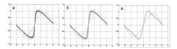
Рис. 2. Разные формы волны на расстоянии x = 1.0 и числа Рейнольдса R = 1000, полученные последовательным суммированием n + 2 гармоник от n = 1 до 30 спектрального решения нелинейных уравнений с различным типом поглощения: внешнее трение — а, квадратичная зависимость уравнение Бюргерса — б и четвертая степень рассеяния — в.
