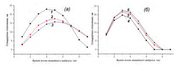
Рис. 5. Стандартное отклонение длины (км) пятна разлива нефти на поверхности воды после аварии в период времени от 1 до 9 часов гипотетического разлива: (а) – в северном, (б) –в южном участках Карского моря. Расстояние от берега такое же, как на рис. 3.
