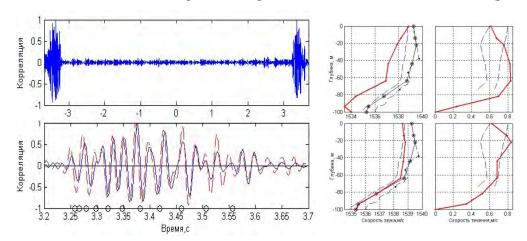
Рис. 8. Функция взаимной корреляции шума (вверху) и ее участки при распространении по (сплошная синяя линия) и против (красная штриховая) течения (внизу). Инверсия (ЛЛТМ) экспериментальных данных. Восстановленные профили – красные линии, исходные— «о», штрихи — интервалы измеренных в эксперименте. Внизу — со слоем осадков, вверху — без.
