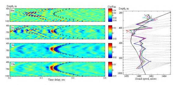
Рис. 7. Слева: оценки функции взаимной корреляции шумов океана для различных времен осреднения. Крестики – рассчитанные времена распространения звука между каждой парой гидрофонов.Справа: результаты инверсии с использованием различного числа лучей между гидрофонами антенн, черная линия – среднегодовой профиль скорости.
