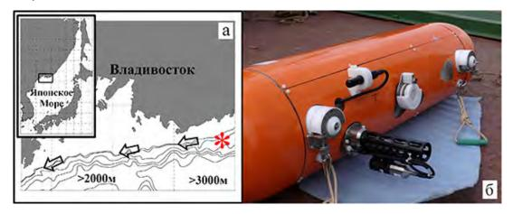
Рис. 1. Рельеф дна в районе исследования (а), изобаты 100, 200, 500, 1000, 2000 и 3000 м; стрелками обозначено Приморское течение, звездочкой – место постановки заякоренной автономной станции. На врезке – Японское море, прямоугольником выделен район исследования. Профилограф Аквалог со встроенным модулем SBE 52-MP CTD (б) на палубе НИС «Академик М.А. Лаврентьев» перед установкой в Японском море в апреле 2015 г.
