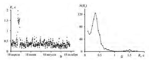
Рис. 2. (а) — оптимальные величины параметра  $R_s(n)$ , полученные в процессе коррекции экспоненциальным фильтром (3) профилей электропроводности, измеренных SBE 52-MP СТD на траекториях подъёма профилографа Аквалог с 18 апреля по 15 октября 2015 г; (б) — повторяемость N параметра экспоненциальной коррекции  $R_s(n)$ .
