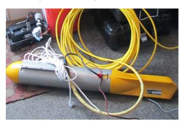
Рис. 3. Высокочастотный ГБО YellowFin.
