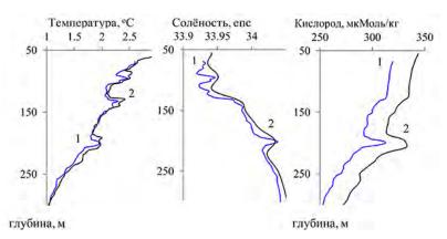
Рис. 4. Вертикальные профили температуры, солености и содержания растворенного в воде кислорода, измеренные 30 мая 2015 г. профилографом Аквалог (1) и на ближайшей станции с борта НИС «Академик М.А. Лаврентьев» (2).
