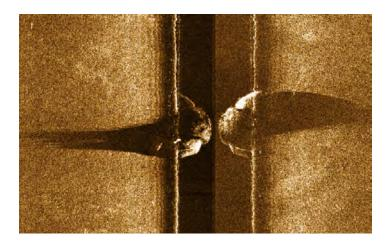
Рис. 4. Гидролокационное изображение реакторного отсека (PO) АПЛ, полученное с помощью ГБО YellowFin в заливе Абросимова.
