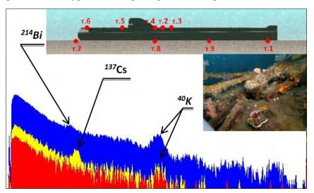
Рис. 16. Спектры, зарегистрированные на корпусе АПЛ К-27 в точках №№ 2, 5 и 9 (обозначены соответственно, желтым, красным и синим цветами); вверху – схема расположения точек на корпусе АПЛ, справа – видеоизображение места проведения измерений у пролома в легком корпусе АПЛ (точка 2), где был найден <sup>137</sup>Cs (Кикнадзе, 2016).
