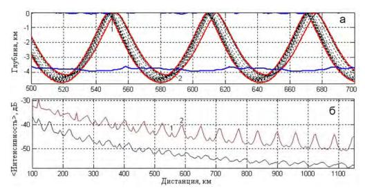
Рис. 2. Слаборасходящийся пучок лучей ( $-11^{\circ}$ ,  $-9^{\circ}$ ) – красные линии и фоновый ( $-8^{\circ}$ ,  $-6^{\circ}$ ) – синие: а – границы (огибающие) лучевых пучков; б – средняя интенсивность звука в пучках.
