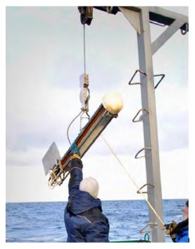
Рис.1. Буксируемый гидролокатор бокового обзора «Мезоскан».
