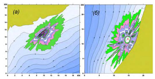
Рис. 2. Толщина пленки нефти (м<sup>-6</sup>) судового топлива на поверхности воды северного (а) и южного (б) участков Карского моря после аварии в точках 2 и 5 в условиях штормового ветра через 4 часа от начала выброса (местоположение точек приведено на рис. 1).
