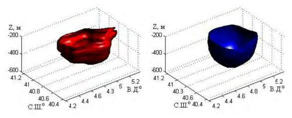
Рис. 4. Изоповерхности, соответствующие значению вариации скорости звука в линзе — 0.75 м/с. Слева — эксперимент, справа — восстановление.
