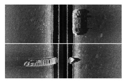
Рис. 13. Типичные гидролокационные изображения затопленных судов с ТРО.
