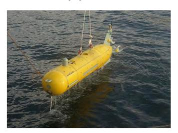
Рис. 5. Автономный необитаемый подводный аппарат «Пилигрим».
