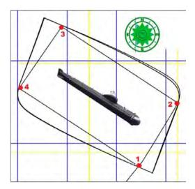
Рис. 6. Маршрут АНПА «Пилигрим» при обследовании АПЛ «К-27». Прямоугольник – запланированный маршрут. 1 и 3 – точки всплытия и коррекции маршрута.
