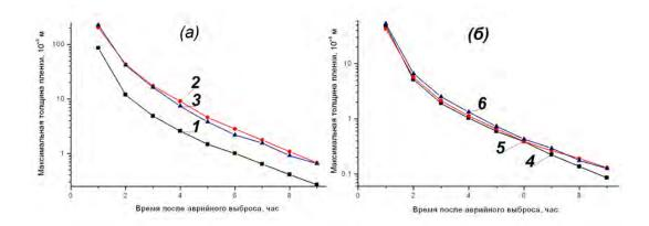
Рис. 7. Максимальные значения толщены пленки ( $10^{-6}$  м) пятна разлива нефти на поверхности воды после аварии в период времени от 1 до 9 после часов гипотетического разлива: (а) — в северном, (б) — в южном участках Карского моря. Расстояние от берега такое же, как на рис. 3.
