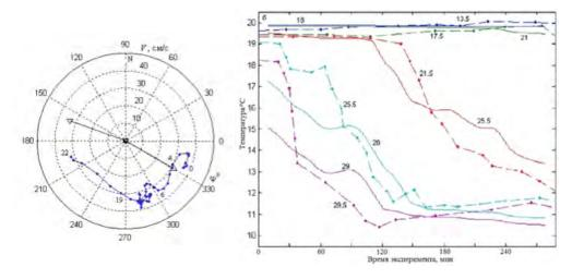
Рис. 11. Сравнение изменения векторов средних скоростей течения, восстановленных методом акустической томографии за 22 часа (точки, каждые полчаса) и двух измерений с помощью ADCP в 5-й (330°) и 25-й (160°) часы (стрелки). Изменение температуры в ходе эксперимента на различных глубинах (цифры в м). Сплошные линии - восстановленное, штриховые - измеренное заякоренной цепочкой термисторов.
