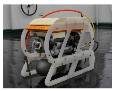
Рис. 15. ТНПА «ГНОМ» с высокочувствительным подводным гамма-спектрометром РЭМ-35-2.
