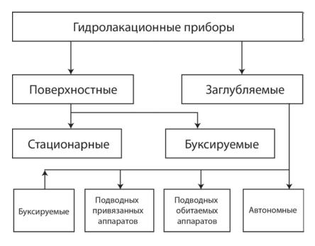
Рис. 1. Схема, иллюстрирующая классификацию гидролокационных приборов.
