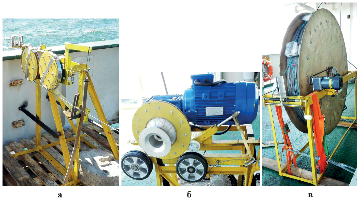
Рис. 3. Механизмы спускоподъемного комплекса; а – устройство для вывода кабеля за борт с тормозом, б – механизм с тянущим шкивом и тормозом, в – кабельная выюшка.
