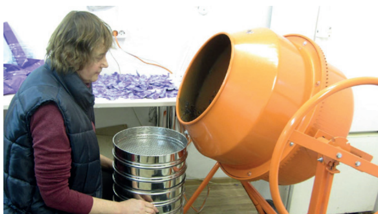
Рис. 4 – Работа с «Балериной» (название, любовно присвоенное бетономешалке) – имитация периодического механического воздействия донного осадка на дробление пластиковых фрагментов в волноприбойной зоне. Фильтрация субстрата через набор сит. г. Калининград, АО ИО РАН. 2015 г. (фотография – Е. Есюкова)
