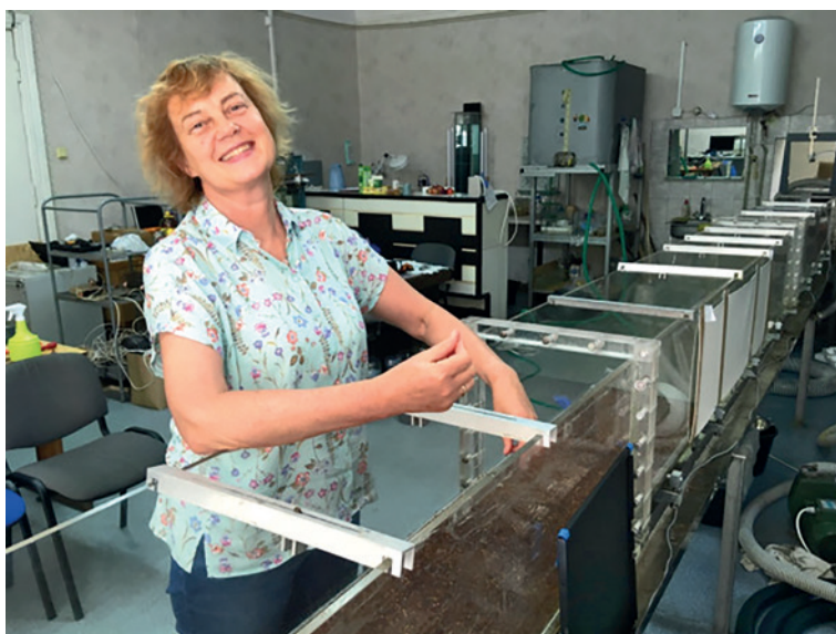
Рис. 3 – Во время подготовки эксперимента по движению частиц микропластика различных форм. Гидролоток в Атлантическом отделении Института океанологии им. П. П. Ширшова РАН, 2019 г. (фотография – Е. Есюкова)
