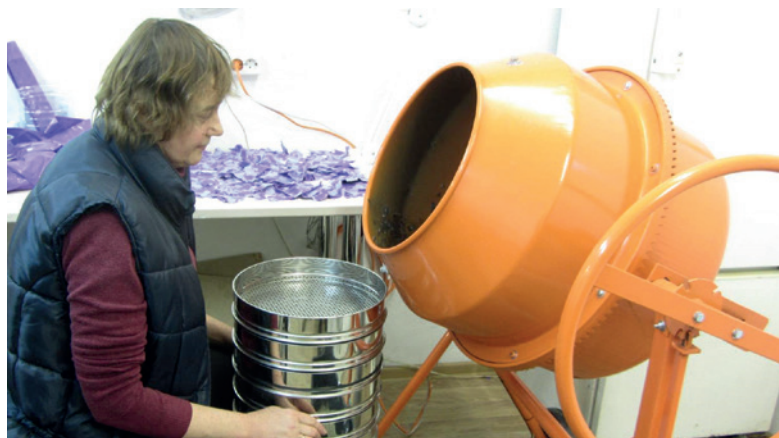
Рис. 4 – Работа с «Балериной» (название, любовно присвоенное бетономешалке) – имитация периодического механического воздействия донного осадка на дробление пластиковых фрагментов в волноприбойной зоне. Фильтрация субстрата через набор сит. г. Калининград, АО ИО РАН. 2015 г. (фотография – Е. Есюкова)
