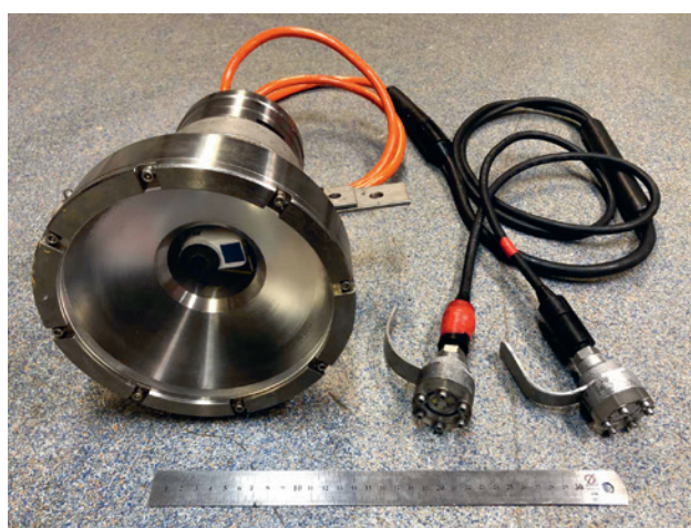
Рис. 2 – Фото комплекта для осуществления подводной видеосъемки в автономном режиме
