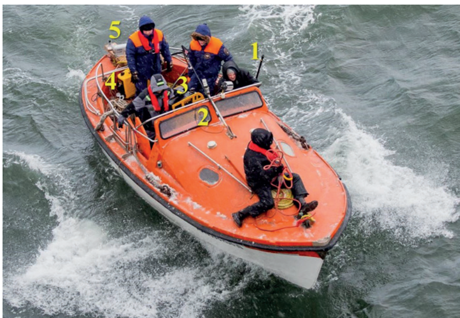
Рис. 1 – Судовой моторный катер: 1 – штанга антенны эхолота, 2 – навигационный эхолот-картплоттер, 3 – ТНПА “RovBuilder-600”, 4 – бензоэлектрический генератор; 5 – электрическая якорная лебедка
