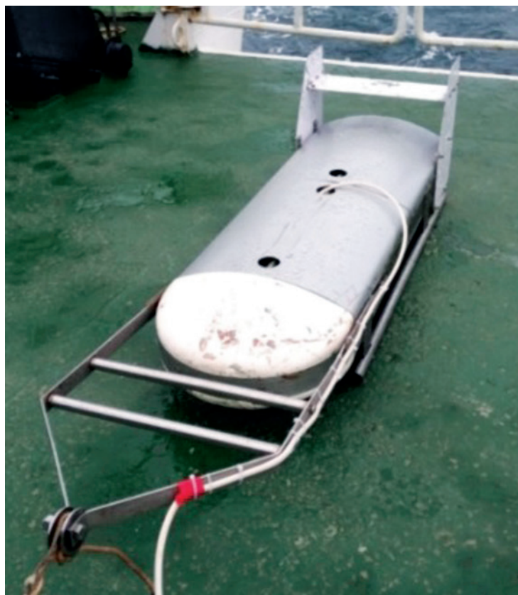
Рис. 2 – Буксируемый носитель акустического профилографа АП-5Т
