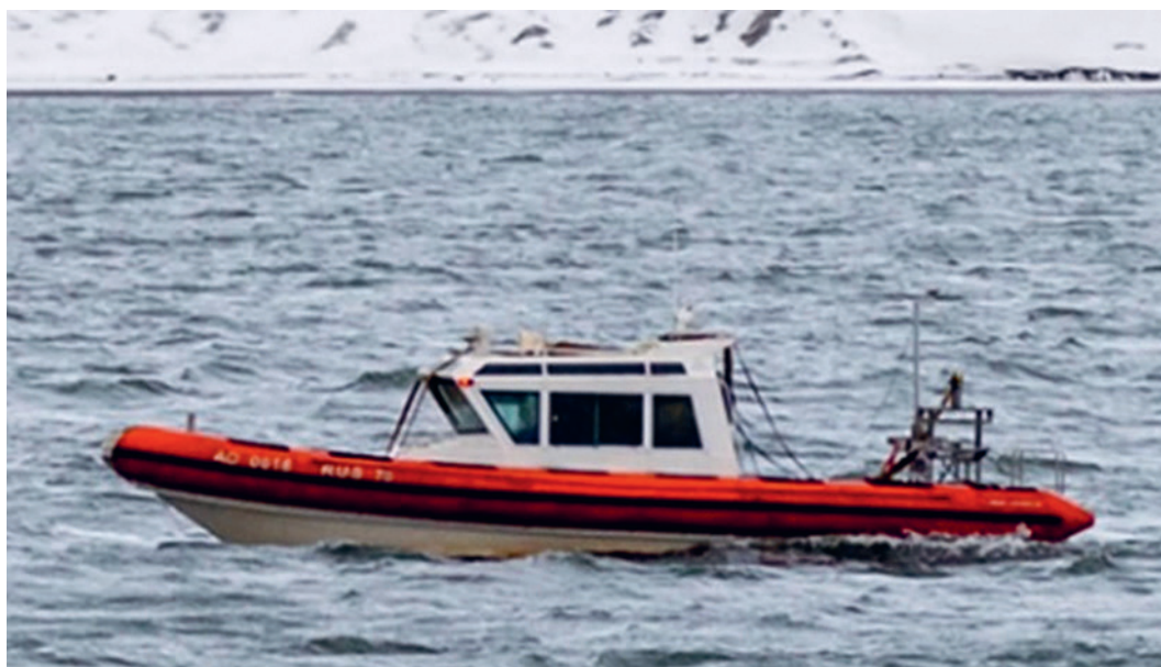
Рис. 4 – Катер Blue Spirit 9.2., оборудованный многолучевым эхолотом (МЛЭ) Reson T50-R. Антенна МЛЭ жестко крепится к борту катера с помощью специального рамного устройства, установленного в кормовой части катера
