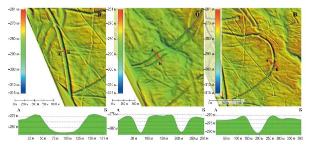
Рис. 3 — Формы борозд ледового выпахивания:  ${\bf a}$  — U-образное выпахивание с характерными бортиками обваловки;  ${\bf 6}$  — борозды, образованные выпахиванием двукилевым палеоайсбергом;  ${\bf b}$  — V-образное выпахивание
