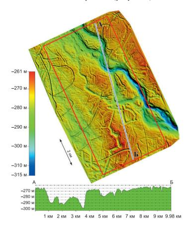
Рис. 2 – Карта-схема рельефа дна площадки
