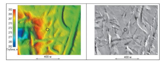
Рис. 14 – Сравнение изображений батиметрии и ГЛБО в районе скважины
