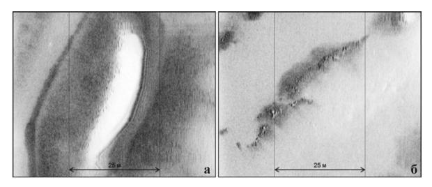
Рис. 13 — Акустическое изображение неровностей рельефа (a) и линейных скоплений валунов (б) на поверхности дна
