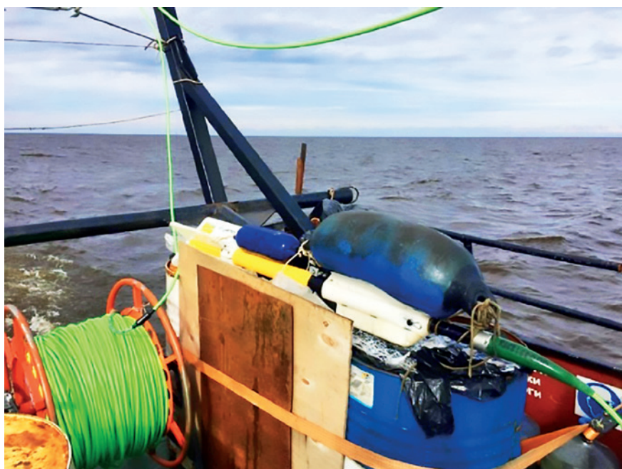
Рис. 10 – Магнитометр G-882, оснащенный для плавучести надувными кранцами (Феоктистов и др., 2022)
