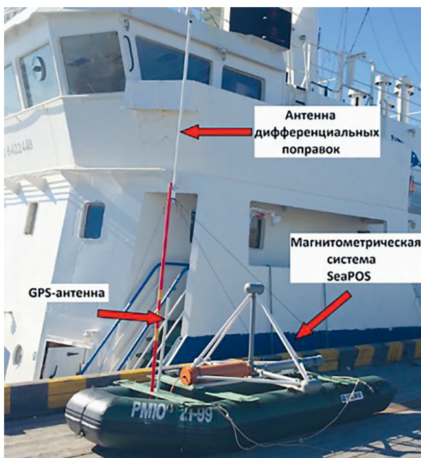
Рис. 2 – Общий вид многоканального магнитометрического и навигационного комплекса (Иваненко, Архипов, Сапунов, 2018)
