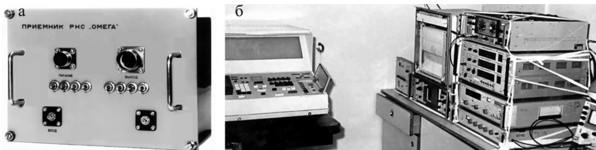
Рис. 2 – Приемник «Омега» (а) и судовой радионавигационный комплекс на его основе (б). Фотоархив авторов
