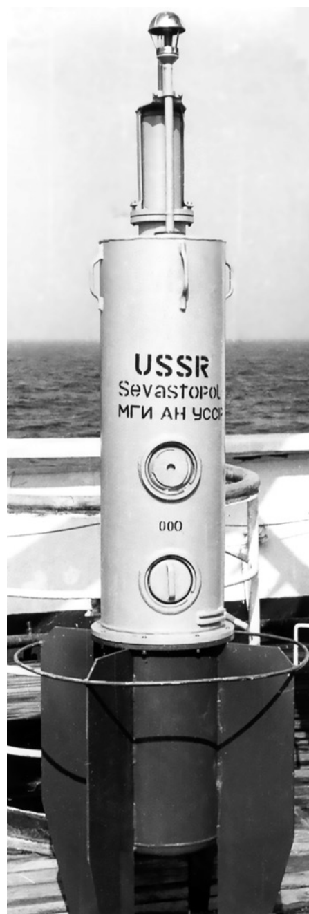
Рис. 3 – Дрейфующий буй ЛОБАН, оснащенный аппаратурой спутниковой связи КОСПАС. Фотоархив авторов
