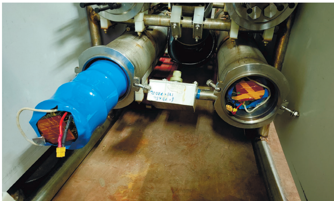
Рис. 3 – Расположение новых источников питания в БНПА «Видеомодуль»: слева – конечный вид аккумуляторной сборки; справа – сборка в корпусе
