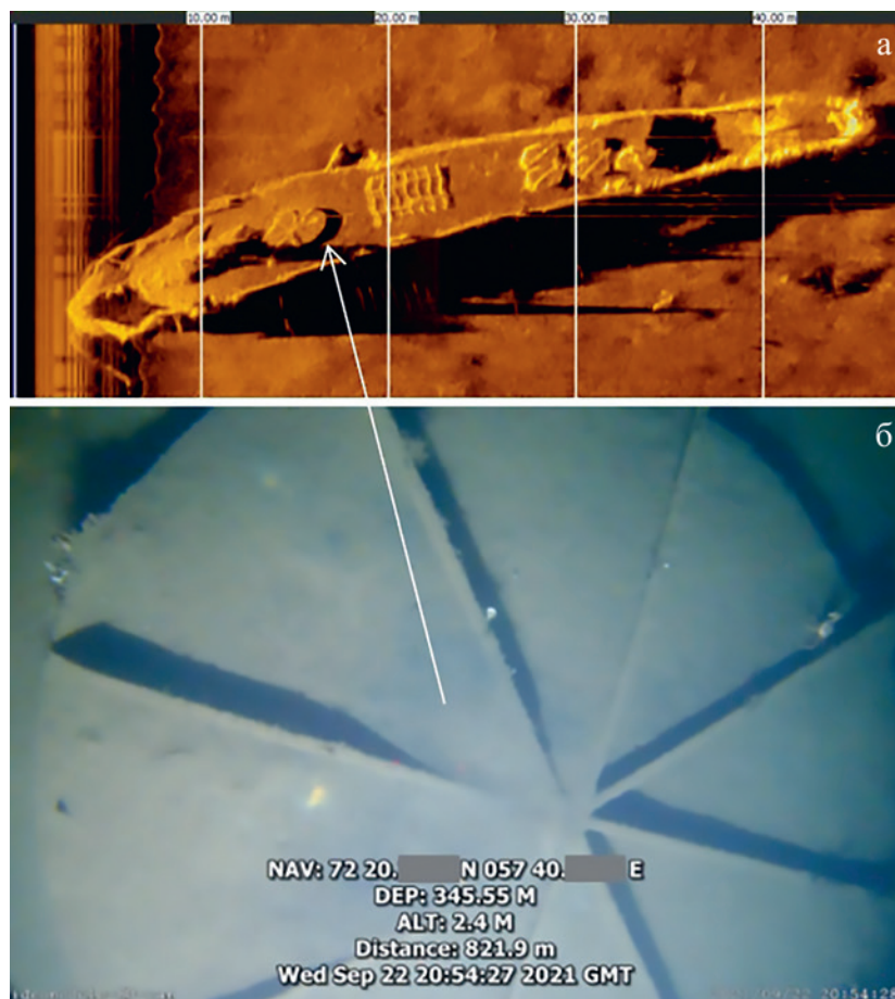
Рис. 10 – Изображения судна, затопленного на полигоне «Впадина-Юг» в Карском море в Новоземельской впадине: а – изображение всего судна, полученное с использованием гидролокатора ГБО-ВМ БНПА «Видеомодуль»; б – стоп-кадр видеозаписи, сделанной с помощью БНПА «Видеомодуль» – крышка люка трюма круглой формы с ребрами жесткости – при буксировке над палубой затопленного судна; место съемки показано стрелкой
