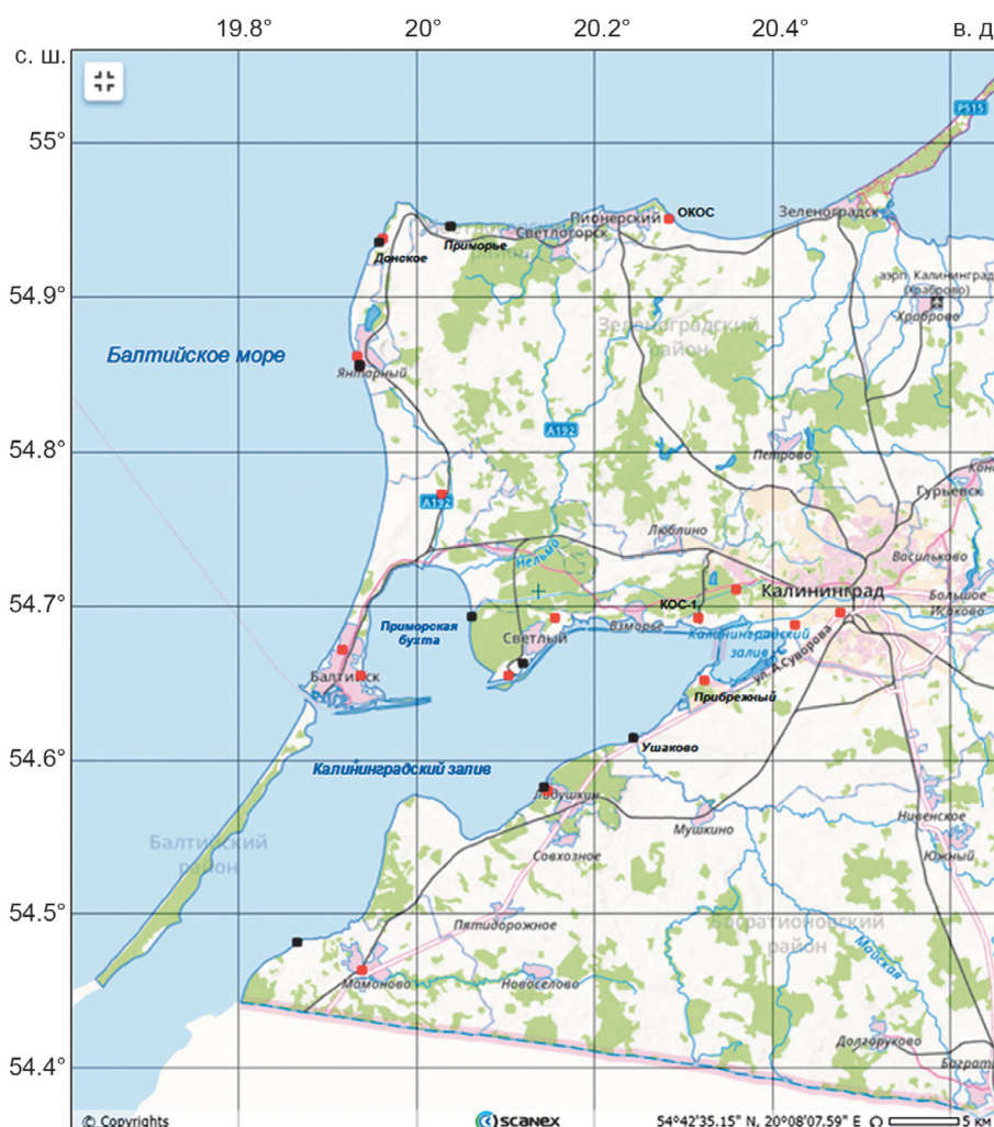
Рис. 4 – Карта Калининградской области, на которой показаны известные КОС – канализационные очистные сооружения (красный) и места сброса в море загрязненных сточных вод (черный), обнаруженные на снимках из космоса и верифицированные с помощью подспутниковых наблюдений, в том числе в августе 2023 г.
