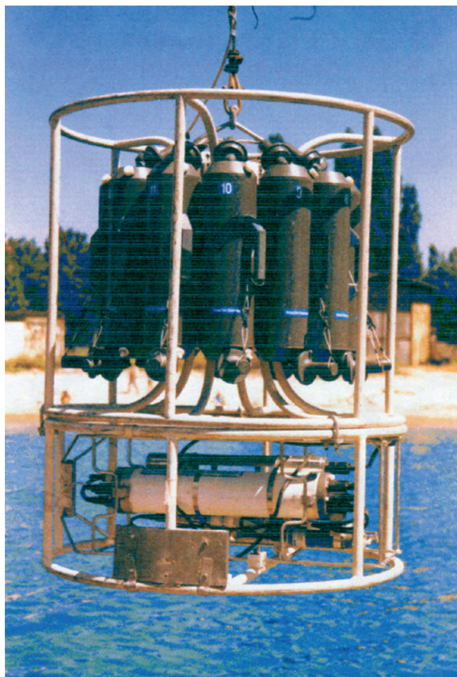
Рис. 4. – Гидрофизический STD-зонд “Sea Bird” и кассета 5-литровых батометров. Фотоархив автора
