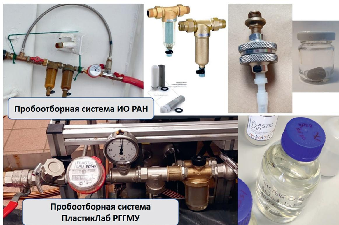
Рис. 2 – Фильтровальные системы лаборатории ИО РАН и ПластикЛаб РГГМУ для использования с проточной системой судна
